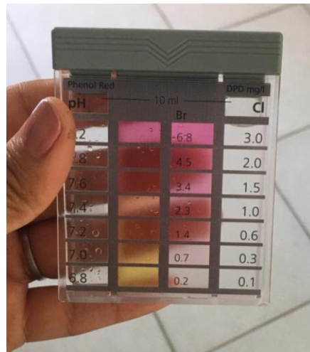
Figura 1. Instrumento para medir el PH, cloro residual de agua potable.
